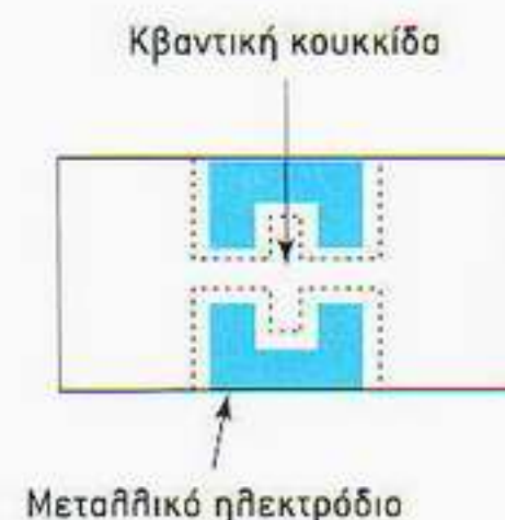
Εικόνα 9.10 Μια «κβαντική κουκκίδα» μπορεί να δημιουργηθεί με το σχηματισμό μεταλλικών πυλών στην επιφάνεια μιας ετεροδομής κβαντικών φρεάτων, όπως η εικονιζόμενη στην Εικόνα 9.8. Οι δύο μικρές στενώσεις αποτελούν «κβαντικές σημειακές επαφές» που απομονώνουν την κβαντική κουκκίδα όταν εφαρμόζεται τάση. Τότε, τα ηλεκτρόνια εισέρχονται στην κουκκίδα μόνο μέσω κβαντικού φαινομένου σήραγγας.
