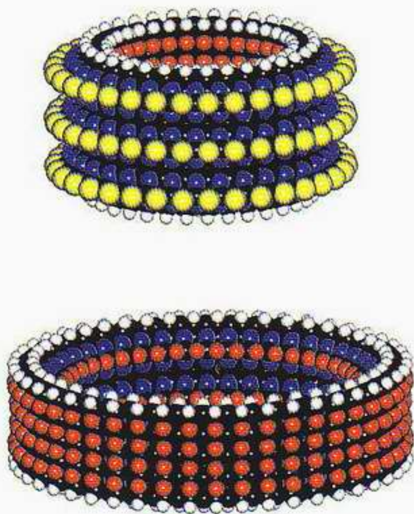
Εικόνα 13.8 Μακρομοριακός τριβέας τον οποίο σχεδίασαν οι Κ. Eric Drexler και Ralph C. Merkle, δύο από τους πιο ένθερμους υποστηρικτές της μοριακής νανοτεχνολογίας. Το βιβλίο του Drexler The Engines of Creation , στο οποίο αναπτύσσει το όραμά του για τη νανοτεχνολογία, εκδόθηκε το 1986. Ο Drexler, όμως, έλαβε το διδακτορικό του δίπλωμα από το MIT μόλις το 1991. Το Τμήμα Ηλεκτρολόγων Μηχανικών και Επιστήμης Υπολογιστών είχε αρνηθεί να τον δεχτεί ως διεπιστημονικό διδακτορικό φοιτητή, και έτσι ο Marvin Minsky τον ενέγραψε στο περίφημο Media Lab του MIT. Μοιρασίοντι ο Drexler παραδέχεται ότι το όραμα που έχει για το μέλλον ίσως γίνει πραγματικότητα έπειτα από αρκετές δεκαετίες, ο συνάδελφός του Ralph Merkle εγκατέστησε το ερευνητικό εργαστήριο Xerox PARC για να εργαστεί σε μια νεοσύστατη εταιρεία νανοτεχνολογίας.
