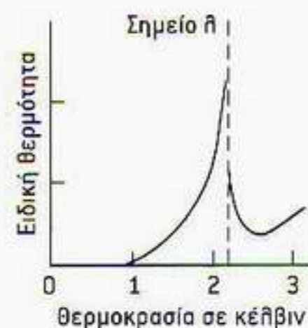
Εικόνα 7.11 Το σημείο λ για το υγρό ήλιο. Πρόκειται για μια ρίζαν ασυνήθης μεταβολή η οποία συμβαίνει στους 2,2 βαθμούς πάνω από το απόλυτο μηδέν, και ο ασυνήθης χαρακτήρας της καθίσταται εμφανής από αυτή την όμοια με λ καμπύλη που προκύπτει από μετρήσεις της ειδικής θερμότητας του ηλίου.
